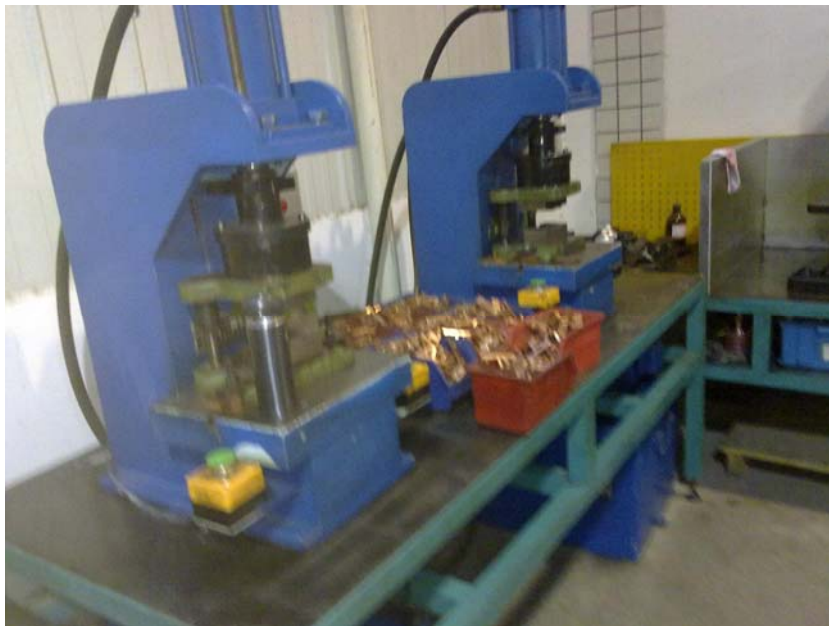
采用设备型号 Y-03 两台非标单臂液压系统
